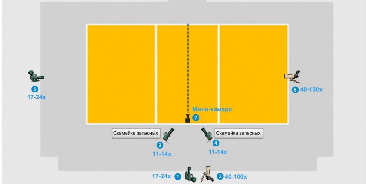
**Камера 1-** Ведущая камера со стандартным объективом , показывающая основной рисунок игры (на штативе с ручками управления фокусом и трансфокатором, и накамерным монитором). Стоит в верхней точке по линии волейбольной сетки.
